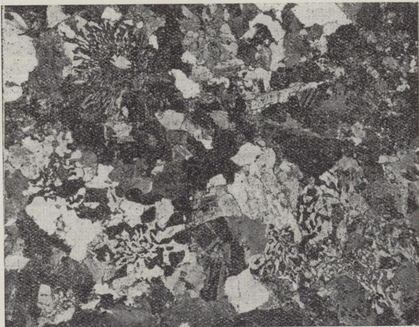
Fot. 12.—Aplita granítica del Km. 66,400 del ferrocarril de Peñarroya a Fuente del Arco. (Fot. F. Mingarro)
