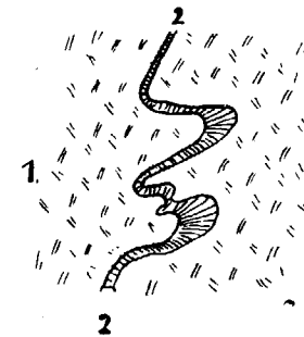
Fig. 20.—1, casiterita contenida en un filón de cuarzo. 2, arsenopirita en filoncillo ondulado atravesando a la casiterita anterior. La Periza. Montánchez. Cáceres.
